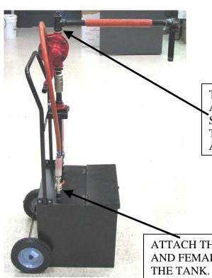
TAKE BLACK PIPE ASSEMBLY AND ATTACH TO TOP OF PUMP AS SHOWN USING TEFLON TAPE.
