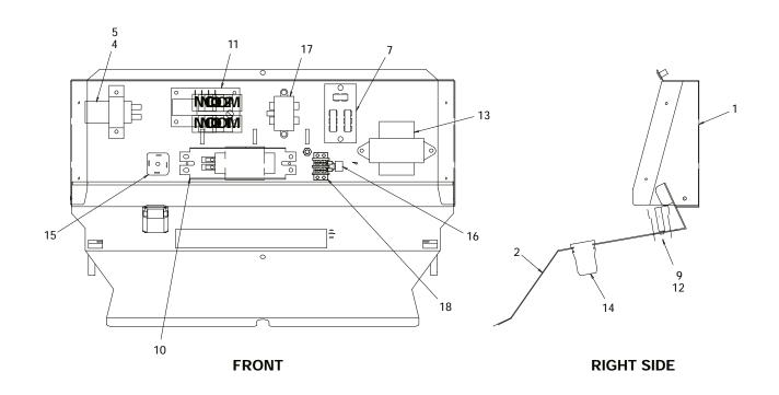
FIGURE 2. ELECTRICAL BOX ASSEMBLY EXPLODED VIEW
