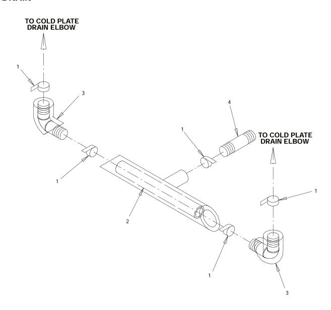
FIGURE 4. COLD PLATE DRAIN FOR Z STYLE UNITS
