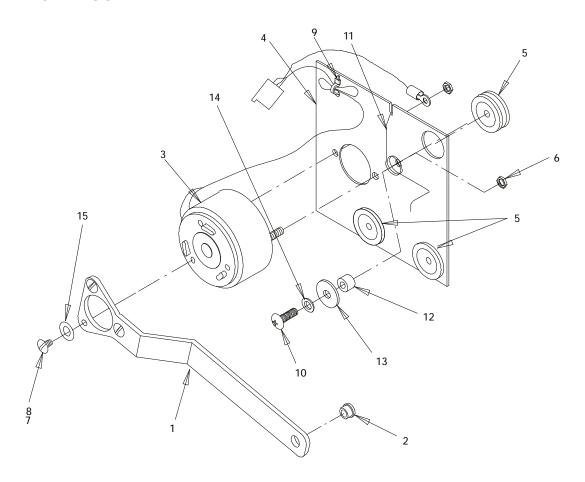
FIGURE 3. SOLENOID ASSEMBLY
