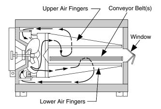
Figure 1-4. PS536ES-Series Oven Air Flow
